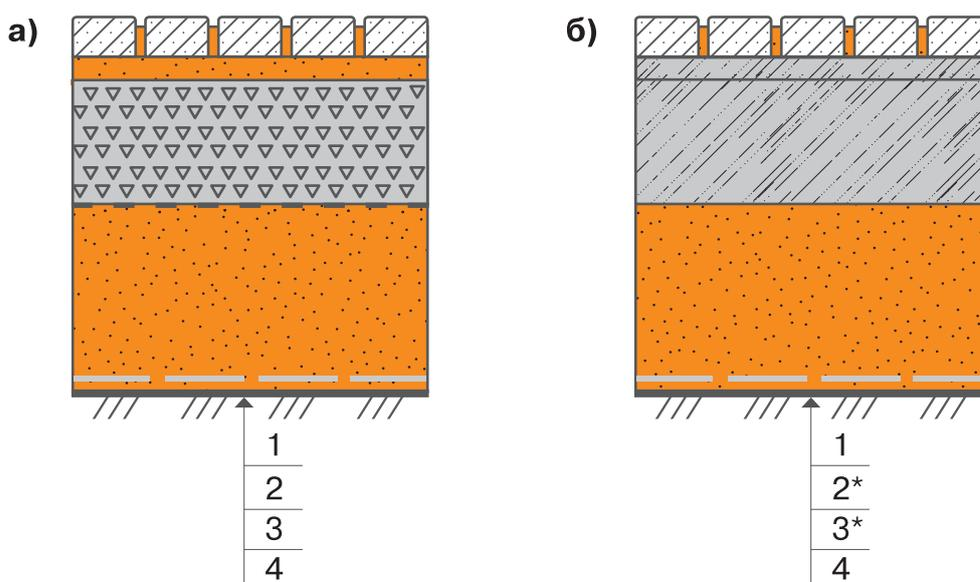
а) Конструктивная схема дорожной одежды нежесткого типа;
