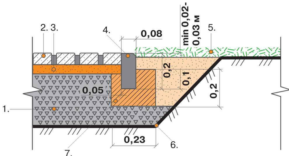
1 - Основание; 2 - Плиты бетонные тротуарные; 3 - Подстилающий слой;
