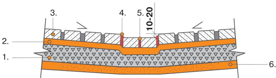
1 - Основание; 2 - Подстилающий слой; 3 - Пли бетонные тротуарные; 4 - Заполнение швов водонепроницаемыми растворами на основе трассово-цементного вяжущего; 5 - Камни/плиты мощения; 6 - Уплотненный грунт
