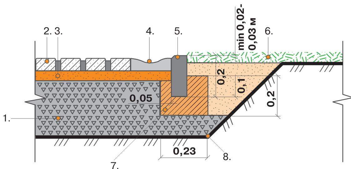
1 - Основание; 2 - Плиты бетонные тротуарные; 3 - Подстилающий слой; 4 - Водоотводной лоток Б1.18.50; 5 - Бордюр тротуарный БР100.20.8; 6 - Плодородный слой почвы (газон); 7 - Бетон класса В15; F150 по ГОСТ 26633; 8 - Уплотненный грунт
