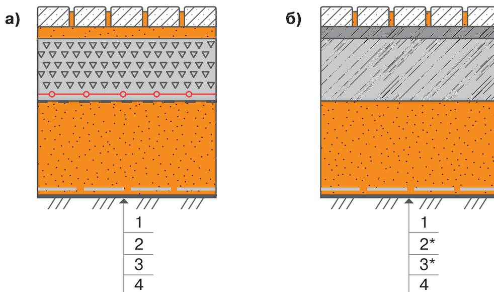
**а)** Конструктивная схема дорожной одежды нежесткого типа;
