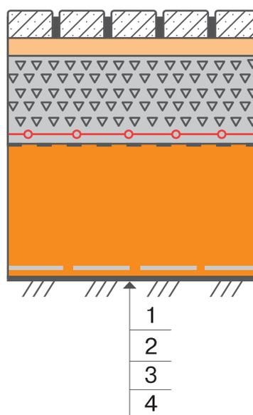
**Рисунок 19.** Конструктивная схема дорожной одежды с покрытием из плит бетонных тротуарных BRAER Группы VI
