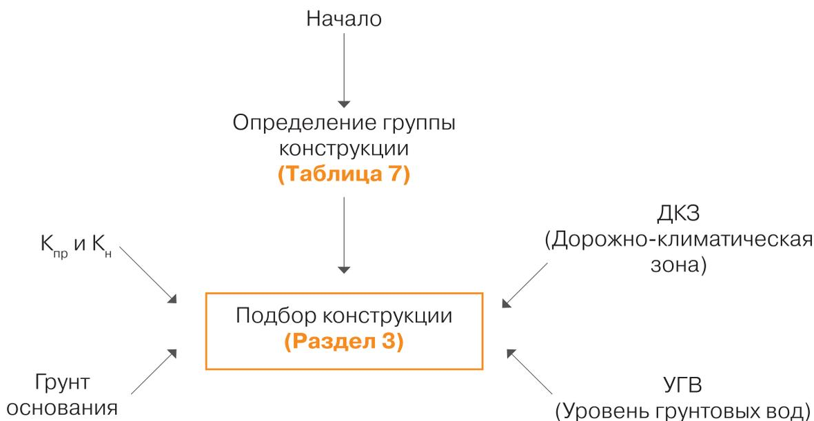
**Рисунок 9.** Блок-схема по использованию альбома технических решений
