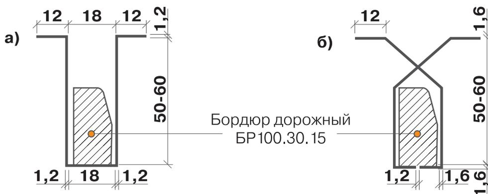
**Рисунок 30.** Специальные ручные приспособления для установки бортовых камней
