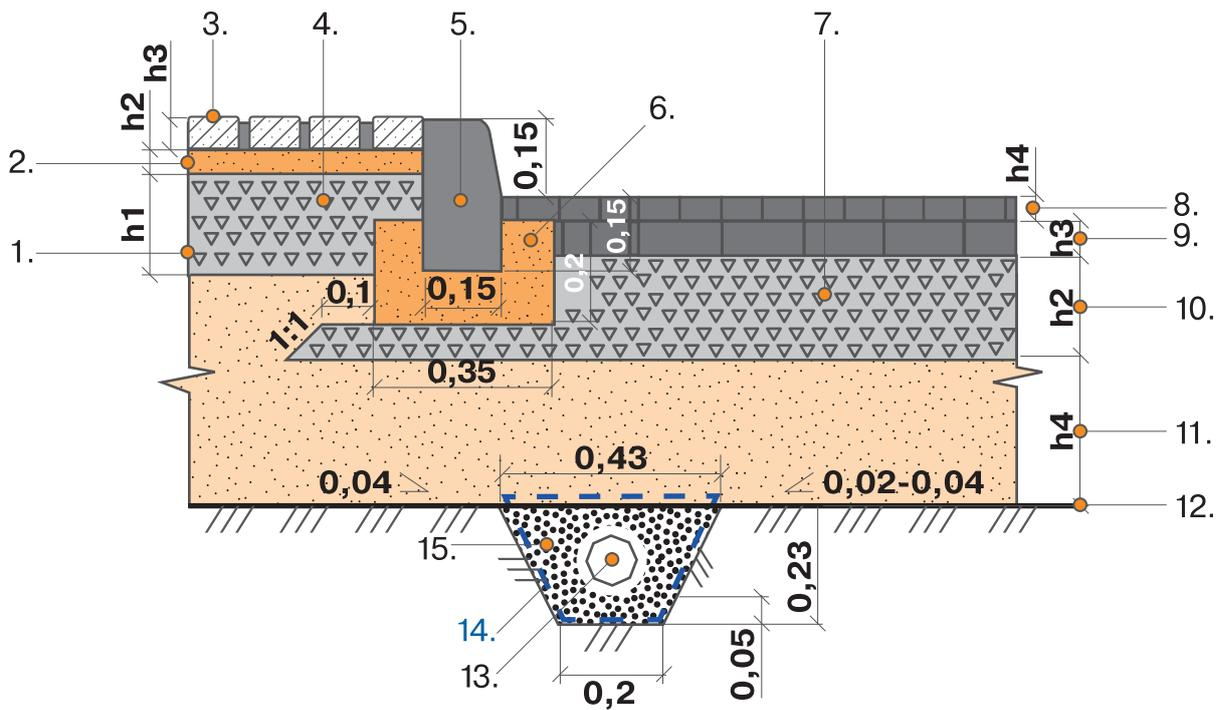
1 - Щебень; 2 - Подстилающий слой; 3 - Плиты бетонные тротуарные;
