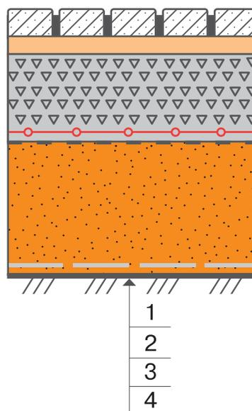
**Рисунок 21.** Конструктивная схема дорожной одежды с покрытием из плит бетонных тротуарных BRAER Группы VII
