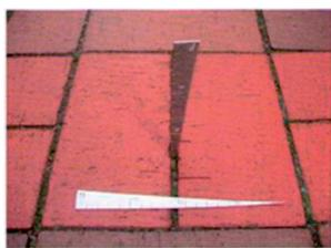
**Рисунок 32.** Измерение ширины шва при восстановлении покрытия
