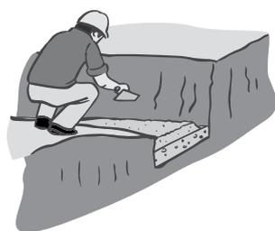
Установить столбики на тощий бетон, заполнить с обеих сторон на 1/3 высоты столбика боковые опоры тощим бетоном и утрамбовать.
